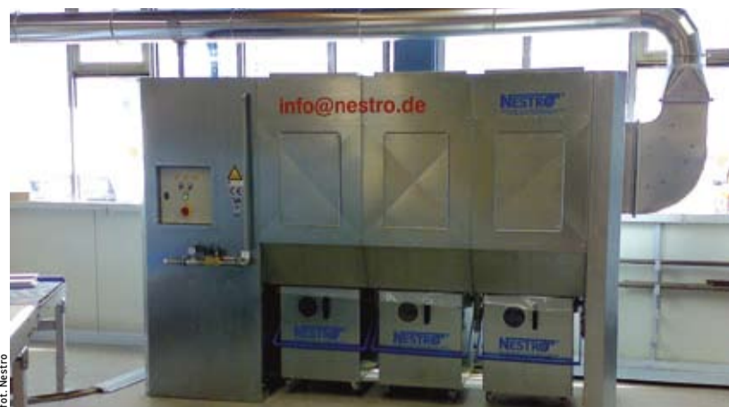
Filtry podciśnieniowe typu NE posiadają zwartą budowę i wyciszony wentylator ssący.
